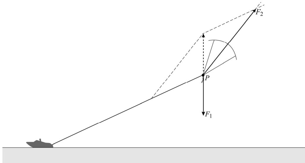
De lengte van de vector  $F_2$  kan worden opgemeten als 39 mm.De schaalfactor kan worden bepaald met behulp van de vector  $F_1$  die een lengte heeft van 19 mm.
